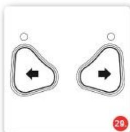
Pomocí tohoto tlačítka zapnete levý nebo pravý ukazatel směru jízdy (obr. 29), abyste ostatním účastníkům silničního provozu naznačili, že chcete změnit směr jízdy doleva či doprava. Opětovným stisknutím tohoto tlačítka ukazatele směru opět vypnete.
