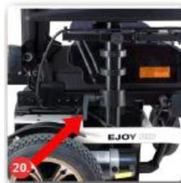
Boční kryty lze zcela odstranit kvůli přemístování osoby stranou. Upozorňuje, že boční kryty lze sejmout, ale nelze je zcela oddělit, aniž by se odpojil kabel řídicích jednotek. Kromě toho lze nastavit výšku loketních opěrek. Nastavení můžete provádět i do stran.
